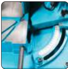
Archet orientable de 0° à 60° à gauche pour des coupes à l'équerre.
