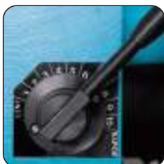
10 Vitesses variables de 500 à 2000 tr/min
