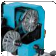
Moteur avec courroie
