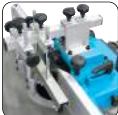
Guide de toupie avec presseurs horizontal et vertical.
