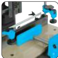
2 presseurs verticaux à serrage rapide et 1 presseur horizontal coulissant
