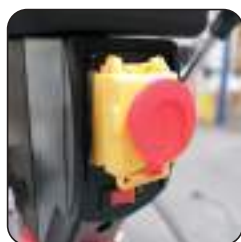
Bouton d'arrêt d'urgence «Coup de poing»
