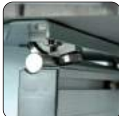
Chariot de tenonnage avec coulissement sur roulements à billes.
