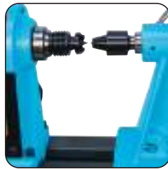
Broche d'entraînement filetée M33 x 3.5mm
