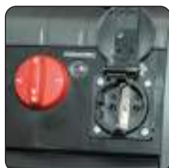
Synchronisation avec machine électroportative
