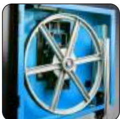
Volants en fonte d'aluminium équilibrés, et contacteurs de sécurité
