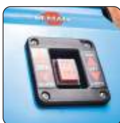
Interrupteur marche/arrêt avec sélection du sens de rotation
