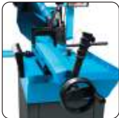
Étau à serrage rapide avec levier à rattrapage de jeu.
